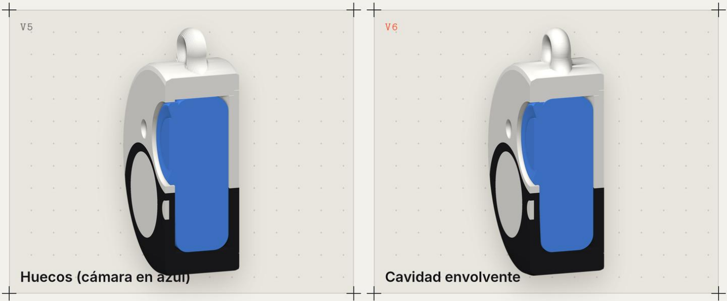
FIG. 12 Corte por el centro del lente. Antes, a la izquierda; después, a la derecha.
