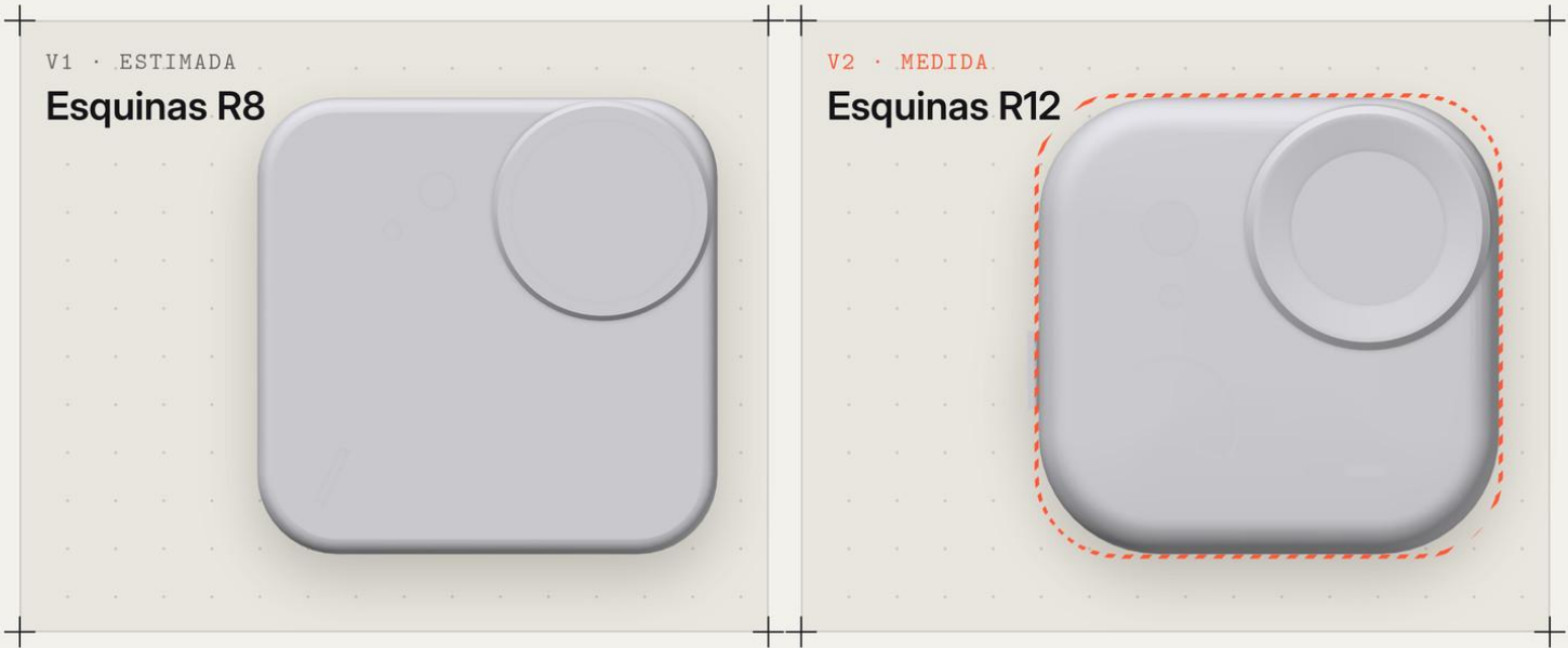
FIG. 06 Maqueta de la cámara. En naranja, el contorno de la v1 sobre la v2.
