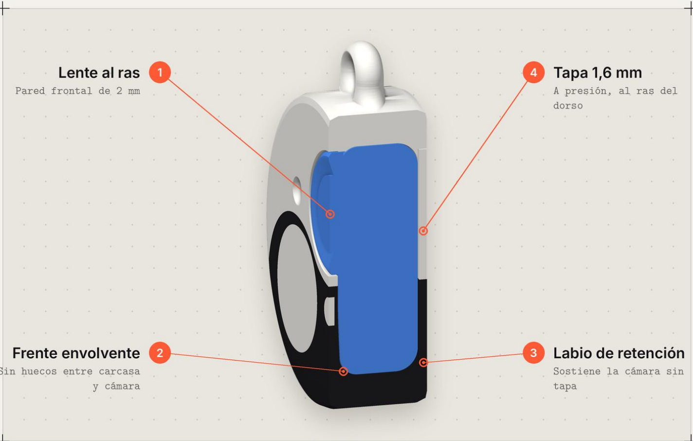
FIG. 13 Corte por el centro del lente. La cámara aparece en azul.
