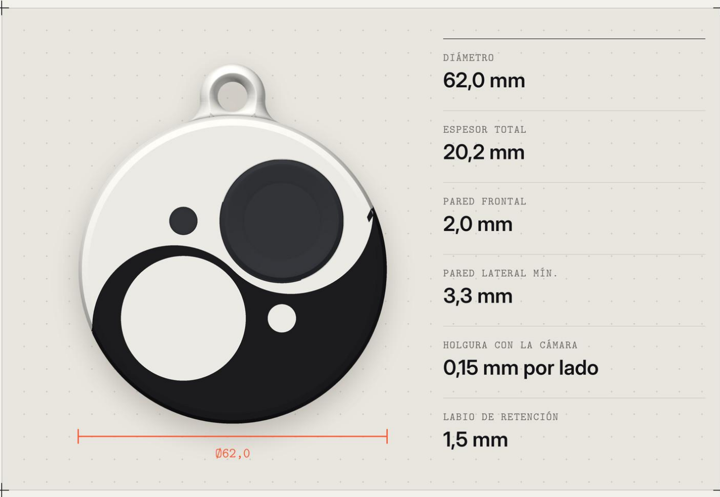
FIG. 14 Vista frontal con la cámara alojada y cota del diámetro.
